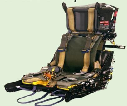
**Assento ejetável**, como um sistema de emergência, normalmente um componente instalado em aviões militares, que tem por objetivo salvar o piloto, no caso de iminente perigo de queda do avião. É um dispositivo projetado para expelir, de maneira rápida e segura, um ocupante da aeronave em caso de necessidade.
