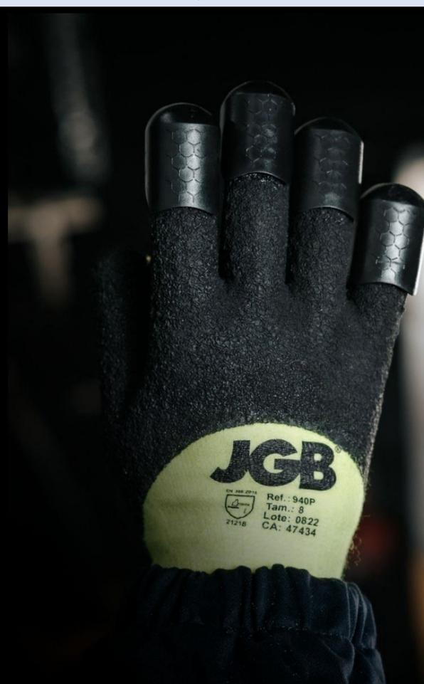
Luva em suporte têxtil de poliéster com revestimento parcial em borracha nitrílica, projetada para alta aderência e **resistência ao impacto**. Com ponteiros em polímero ABS e proteção nível B contra cortes, oferece **conforto, destreza e segurança** em ambientes exigentes.
