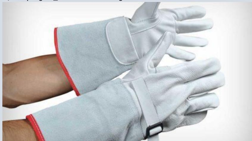
**A luva de cobertura é um EPI de uso obrigatório sobre a luva isolante de borracha. Sua função é oferecer proteção mecânica contra cortes, abrasão e perfurações, preservando a integridade dielétrica da luva primária e, consequentemente, a segurança do trabalhador.**
